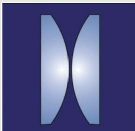
Apochromatische Linsensysteme verbinden die randscharfe Abbildung eines Aplanaten mit der Farbkorrektur eines Achromaten. Linsensysteme wie diese kommen in Messlupen zum Einsatz, bei denen nicht nur eine randscharfe Abbildung gefordert wird, sondern auch eine farbkorrigierte Abbildung sehr wichtig ist.
