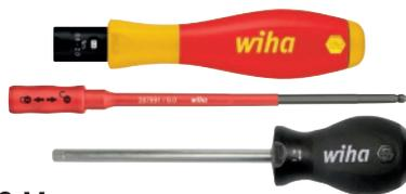
**Drehmomentgriff VDE isoliert TorqueVario®-S VDE mit stufenlos einstellbarem Drehmoment und integrierter Fensterskala · mit SoftFinish® Mehrkomponentengriff · Klinge isoliert · stückgeprüft gemäß IEC 60900** · numerische Anzeige des gewählten Drehmomentwertes · Klicksignal beim Erreichen des eingestellten Drehmomentwertes · Auslösegenauigkeit ± 6 % vom eingestellten Skalenwert
